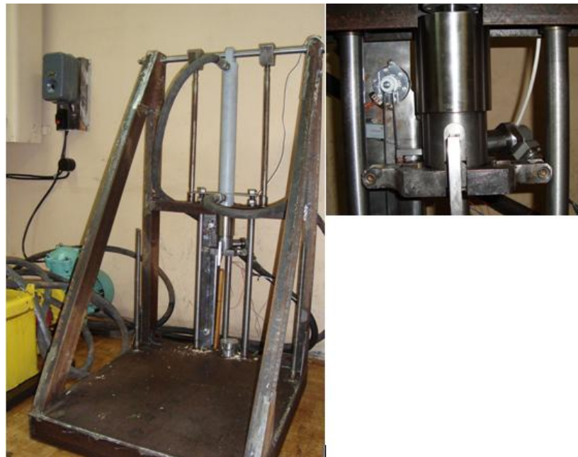
Рисунок 3.11 – Общий вид лабораторной стендовой установки (отдельно показан измерительный гидроцилиндр с резцом, датчиками давления и перемещения)
