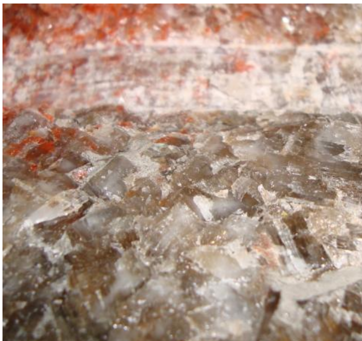
Рисунок 3.2 – Поверхность борозды развала при разрушении блока калийной руды резом с выровненной поверхности
