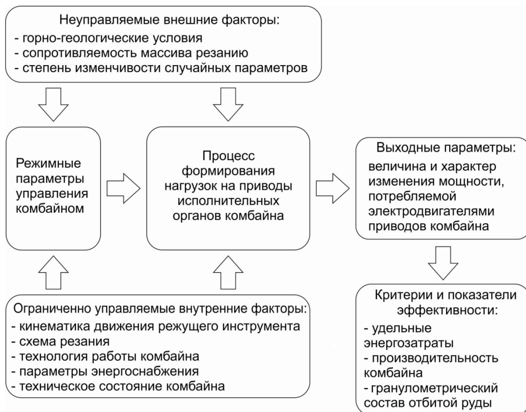
Рисунок 1.22 – Формирование нагрузок в элементах приводов исполнительных органов комбайнов калийных рудников
