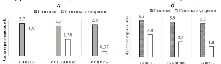
Рисунок 5 — Диаграммы сил страгивания порции зерна (а) и давления воздуха для ее отрыва (б)
