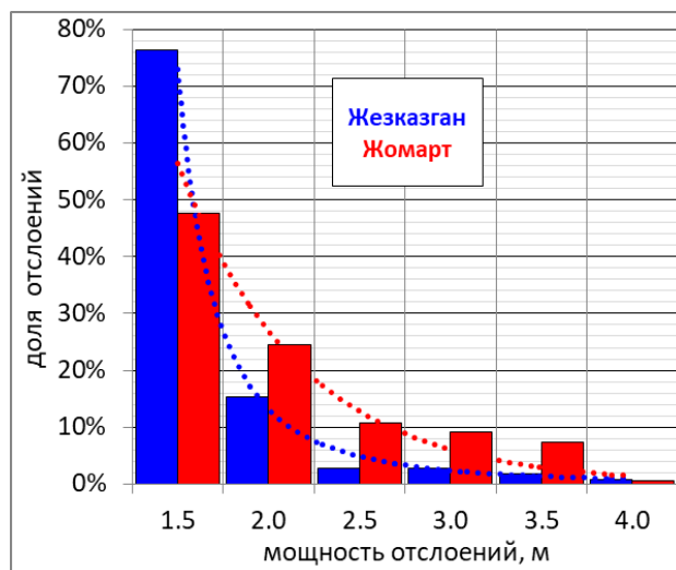
Рисунок 1.6 – Сопоставление мощности отслоений кровли очистных камер в Жезказгане и Жомарте
