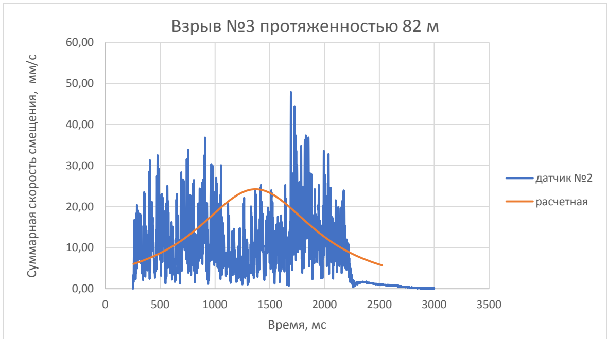
Рисунок 4.9 – Зависимость скорости от времени, взрыв №3
