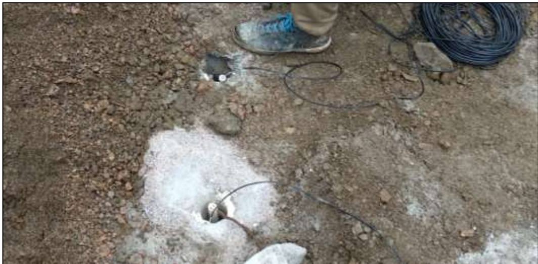
Рисунок 3.13 – Фотография установки пьезо-датчика в измерительную скважину [64]
