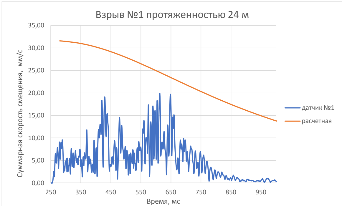
Рисунок 4.5 – Зависимость скорости от времени, взрыв №1
