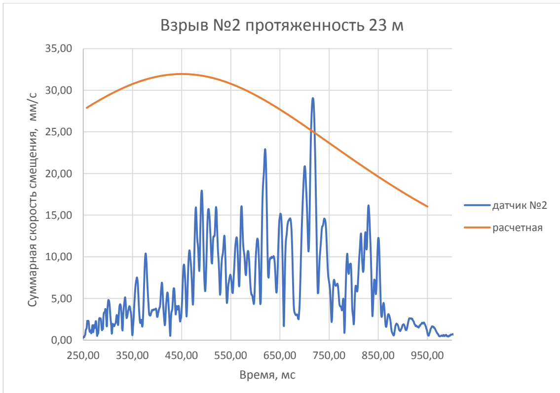
Рисунок 4.7 – Зависимость скорости от времени, взрыв №2
