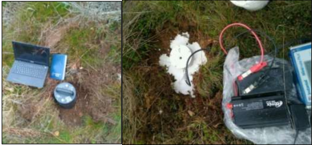
Рисунок 4.3 – Пример установки датчиков
