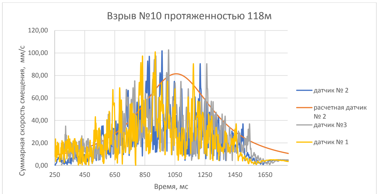
Рисунок 4.11– Зависимость скорости от времени, взрыв №10
