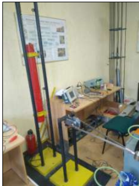
Рисунок 3.7 – Фотография лабораторной установки, на которой проводилась тарировка акселерометров
