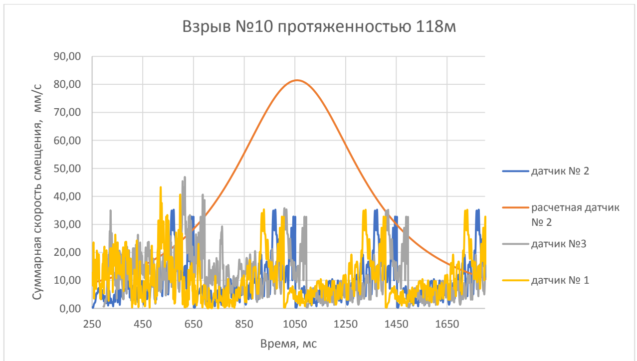
Рисунок 4.12 – Модельная зависимость скорости от времени, при применении увеличенных интервалов замедления
