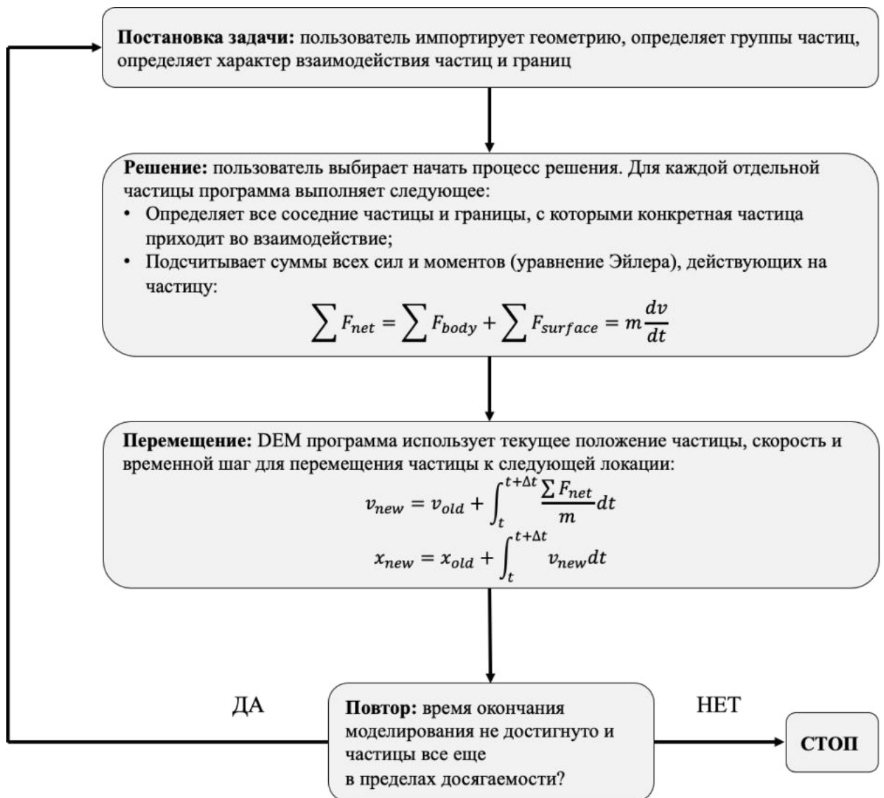
Рисунок 1.11 – Схематический алгоритм DEM программы, где F – сила, m – масса, t – время, v – скорость и x – положение.
