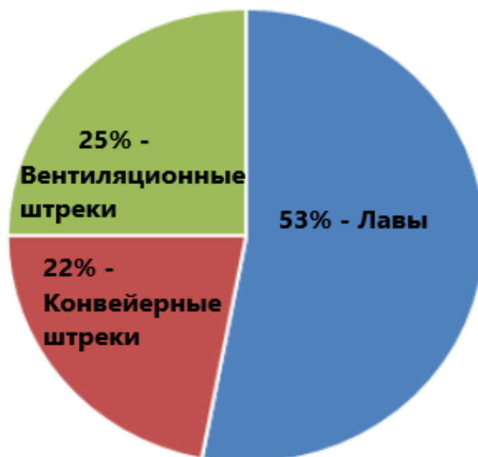
Рисунок 2.3 – Травматизм на угольных шахтах Кузбасса за период 2011-2020 гг. в соответствии с типом горных выработок [98]
