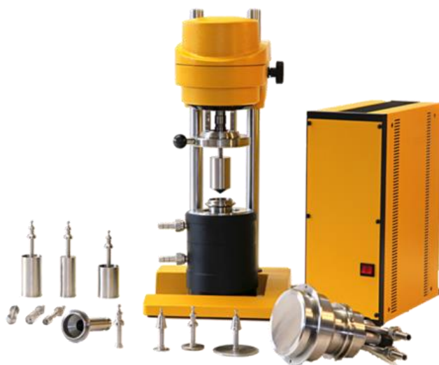
Рисунок 2.3 – Ротационный вискозиметр Rheotest RN 4.1
