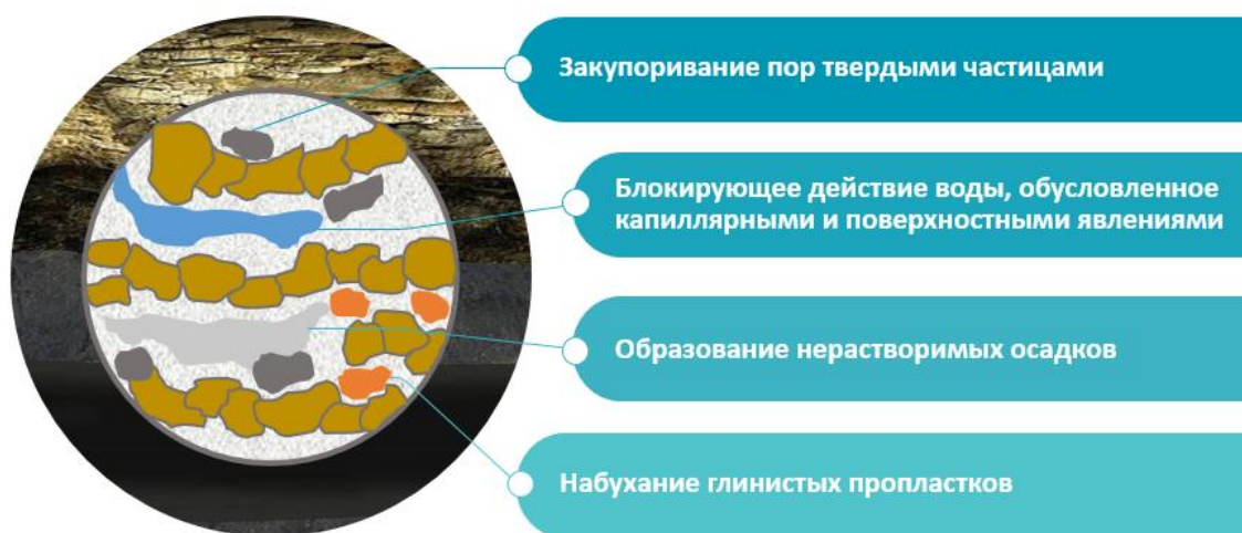
Рисунок 1.7 – Процессы, приводящие к кольтматации
