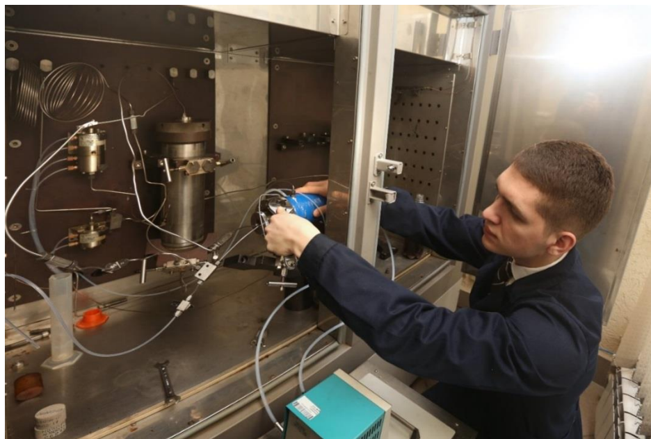
Рисунок 2.10 – Кернодержатель и термошкаф фильтрационной установки FDES-645
