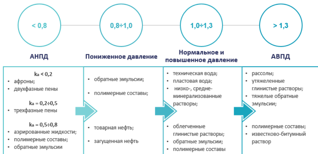
Рисунок 1.9 – Область применения ЖГС в зависимости от коэффициента аномальности пластового давления
