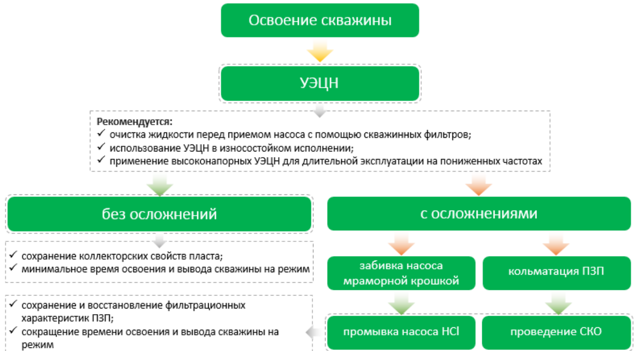
Рисунок 4.5 – Схема освоения скважины после проведения подземного ремонта с (и без) учета осложнений
