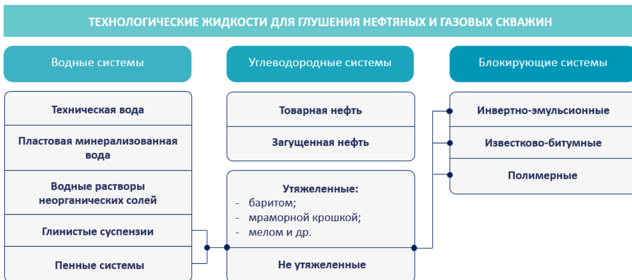
Рисунок 1.2 – Категории технологических жидкостей глушения скважин
