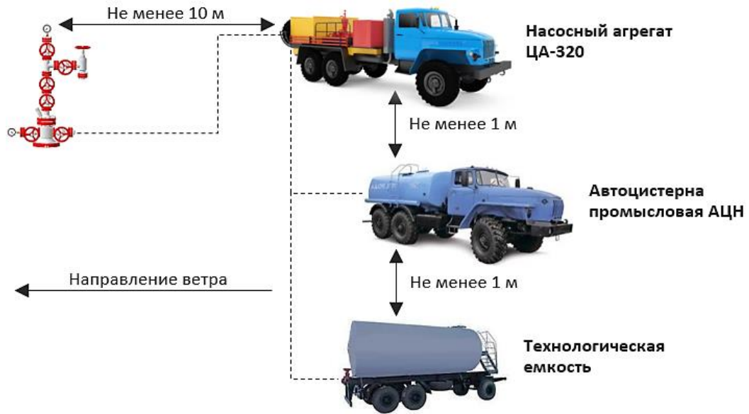
Рисунок 4.2 – Схема расстановки техники при глушении скважины
