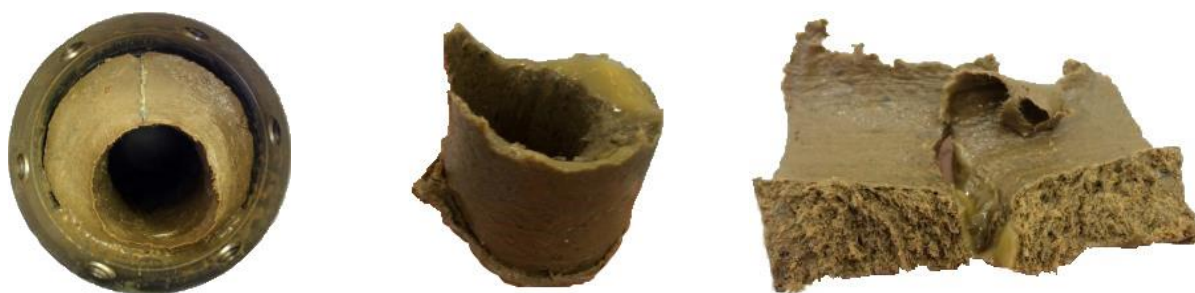
Рисунок 3.7 – Внешний вид антифильтрационной присадки Diaseal M после фильтрации блокирующего состава 16 % Diaseal M (в водном растворе \text{CaCl}_2 ) + БГЭР (трещина раскрытостью 0,1 мм)
