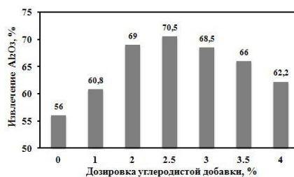
Рисунок 7 - Зависимость извлечения Al 2 O 3 от дозировки древесного угля в шихту при температуре спекания 1250°C.
