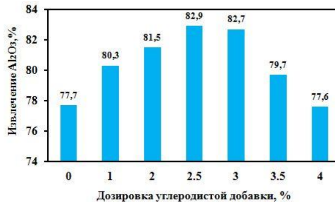
Рисунок 8 - Зависимость извлечения Al 2 O 3 от дозировки анодного угля в шихту при температуре спекания 1360°C
