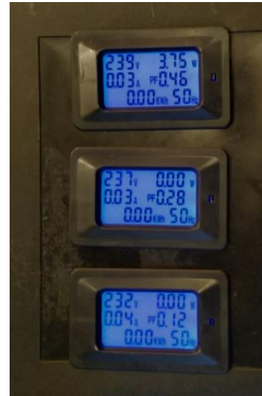
Рисунок 2.7 – Трехфазный ваттметр, изготовленный для замеров мощности мельниц
