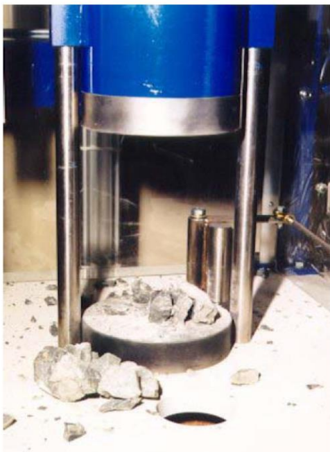
Рисунок 2.11 – Общий вид и схема устройства тестера падающего груза
