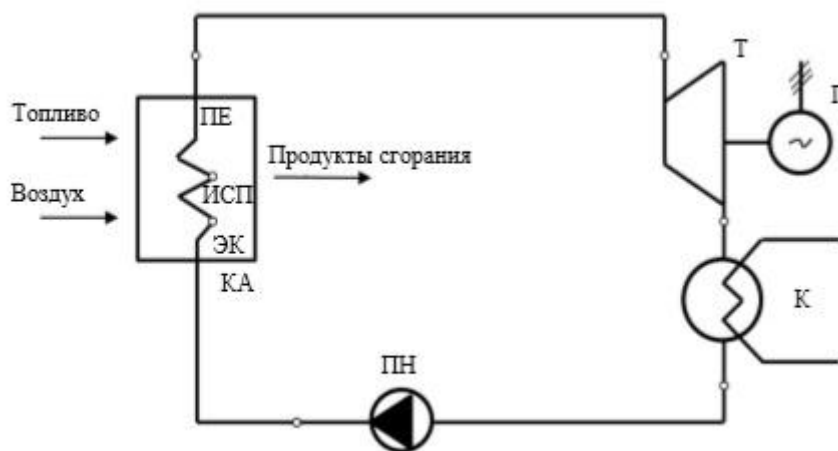
Рисунок 1.7 – Схема паротурбинной установки
