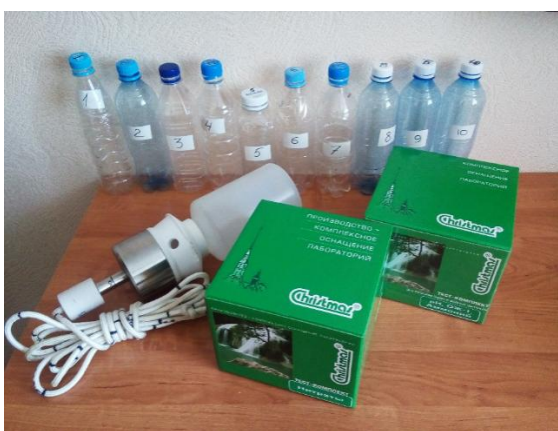
Рисунок 2.2 – Пробоотборная система «ПЭ-1110», тест-комплекты «Пчелка».
