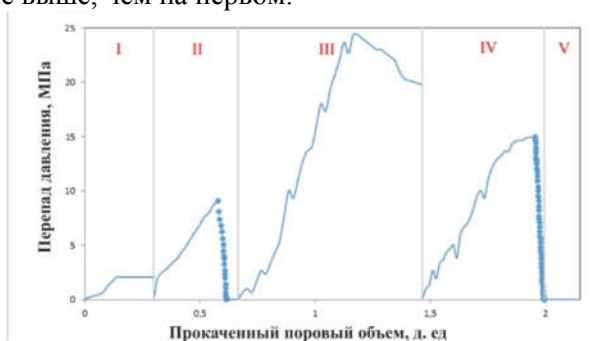
Рисунок 7 – Динамика давления закачки в течении закачки кислотного состава при расходе жидкости 0,5 см 3 /мин и температуре 60 °С относительно прокаченной кислоты в поровых объемах (д. ед)
