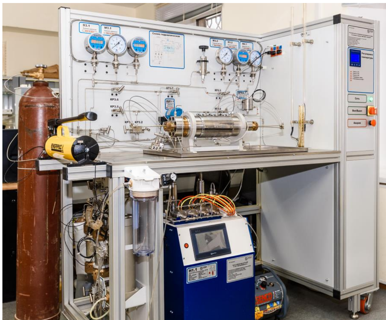
Рисунок 2.5 – Внешний вид установки ПИК-ОФП-1-40-АР/РР, компании АО «Геологика» в комплектации ФГБОУ ВО СамГТУ
