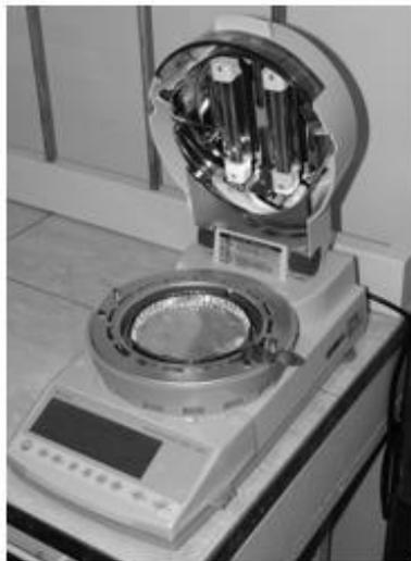
Рисунок 3.2 – Весовой анализатор влажности МОС – 120Н
