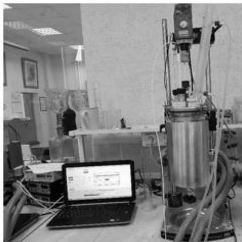
Рисунок 4.2 - Высокотехнологичная реакторная система HEL для проведения укрупнено-лабораторных экспериментов по декомпозиции и карбонизации алюминатных растворов
