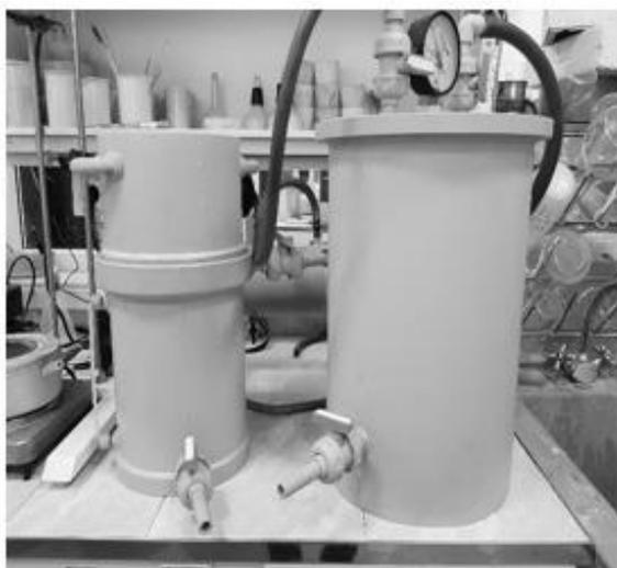
Рисунок 4.10 - Укрупненно-лабораторный нутч-фильтр.
