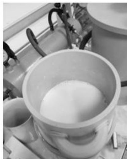
Рисунок 4.11 - Отфильтрованный и отмытый осадок тонкодисперсного гидроксида алюминия.
