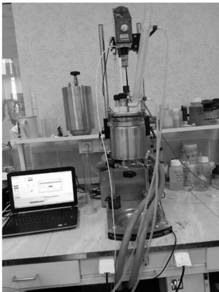
Рисунок 3.6 - Однореакторная система AutoLab со стальным реактором для исследования процессов карбонизации алюминатных растворов.
