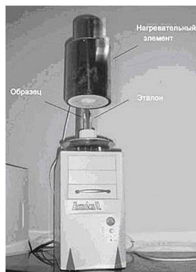
Рисунок 3.19 - Составляющие части «Термоскан»
