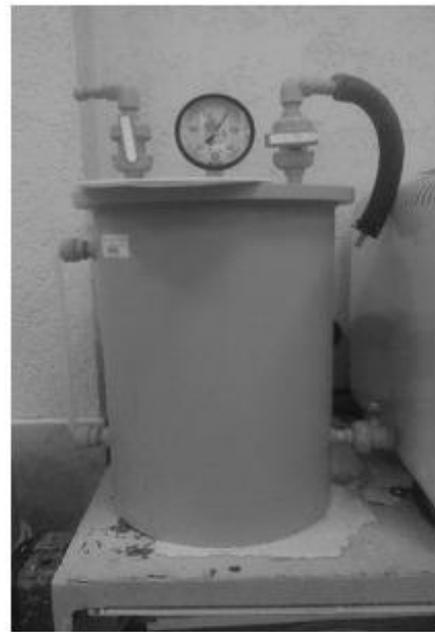
Рисунок 3.9 - Ресивер воздуха отечественного производства для наиболее быстрого и удобного процесса фильтрации тонкодисперсных осадков.
