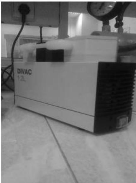
Рисунок 3.8 -Мембранный вакуум-насос компании Divac рабочим объемом 1,2 л.
