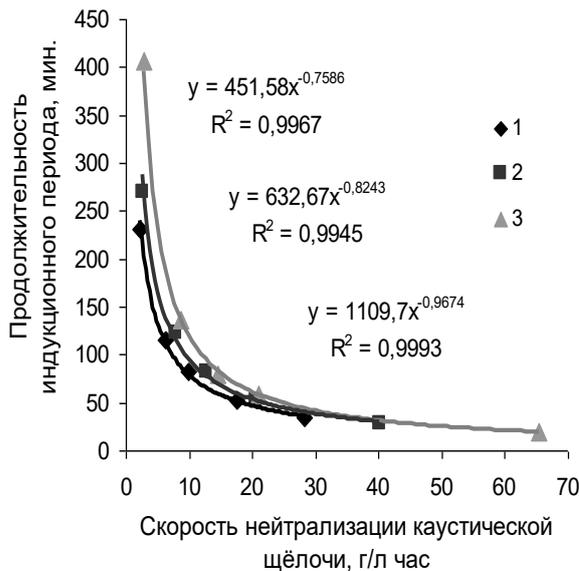
Рисунок 2.9 - Продолжительности индукционного периода в зависимости от скорости карбонизации (нейтрализации) алюминатных растворов при температуре процесса: 1 – 40; 2 – 60; 3 – 80°C. Исходный состав раствора, г/л:  $\text{Na}_2\text{O}_к$  – 67,9;  $\text{Al}_2\text{O}_3$  – 65,3;  $(\alpha_к)$  – 1,71
