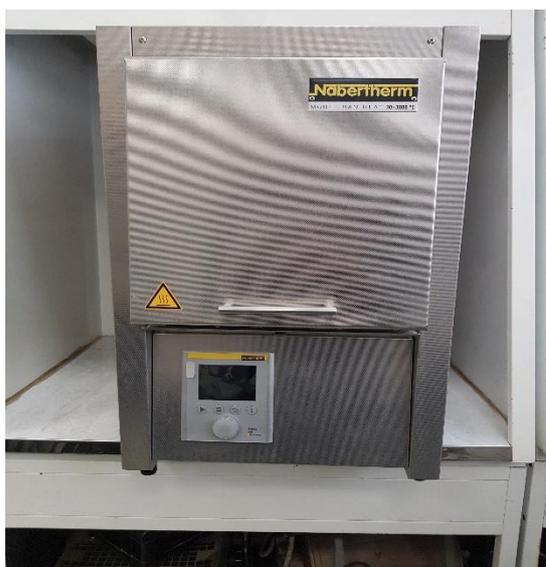
Рисунок 4.29 - Высокотемпературная муфельная печь Nabertherm
