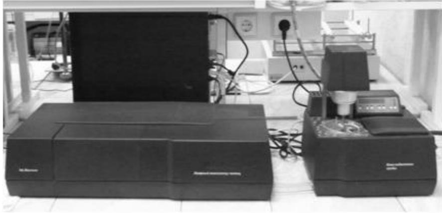
Рисунок 3.14 - Лазерный анализатор частиц Микросайзер 201С
