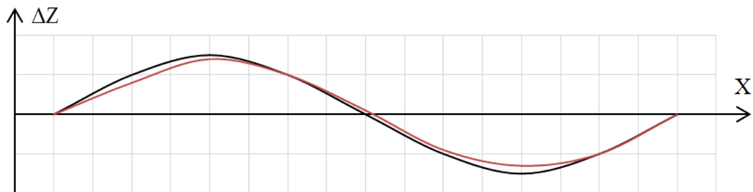
Рисунок 2.6 – График разностей между измеренными и прогнозными значениями оседаний реперов профильной линии
