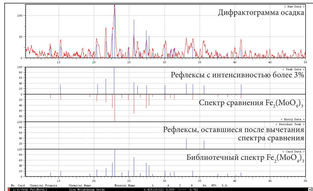
Рисунок 3 – Дифрактограмма продукта, образующегося в результате очистки модельного раствора от молибдена, и библиотечный спектр сравнения Fe_2(MoO_4)_3
