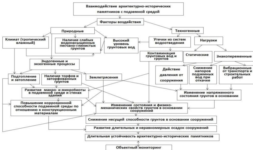
Рисунок 8 - Блок-диаграмма концепции, структуры и содержания объектного мониторинга некоторых архитектурно-исторических памятников Ханоя
