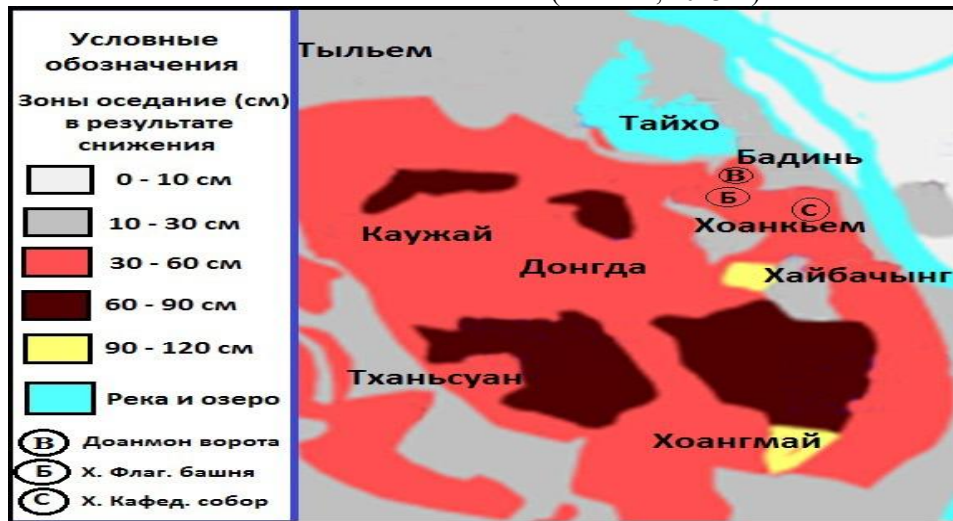
Рисунок 5 - Карта оседания земной поверхности на территории г. Ханоя в результате использования подземных вод в 2013 г.
