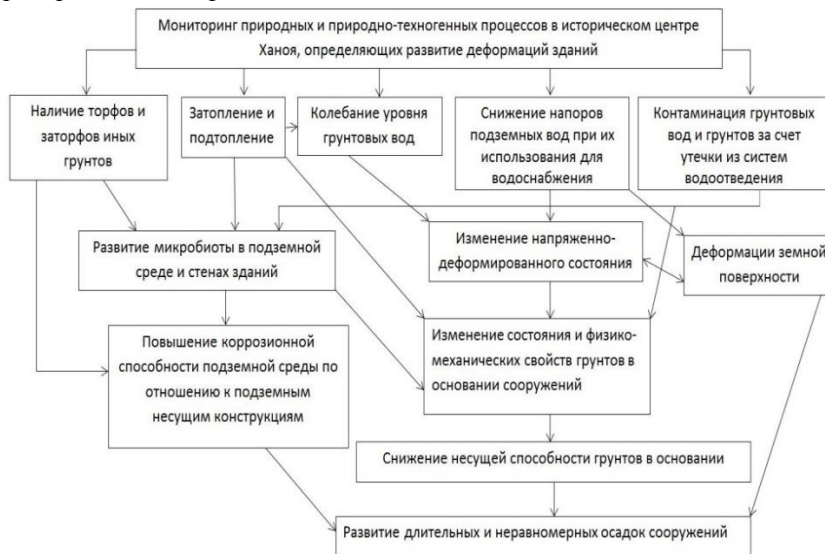
Рисунок 6 - Структура и содержание комплексного инженерно-геологического мониторинга исторического центра Ханоя
