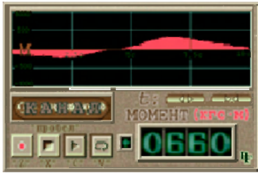
осциллограмма приращения крутящего момента при P = 120 кН
