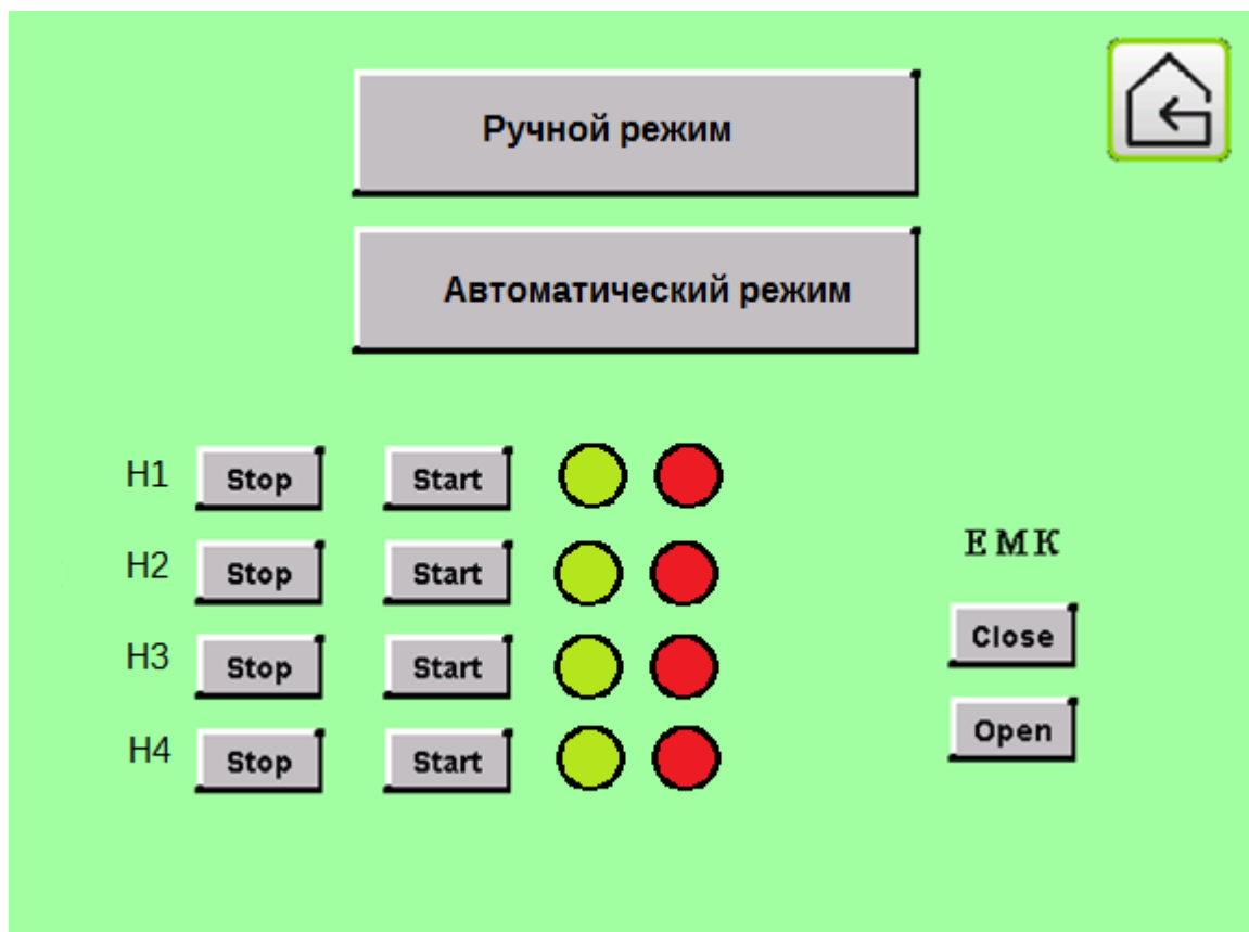
Рисунок 52 – Экран оператора при работе программы (выбора режима работы и управления насосами)
