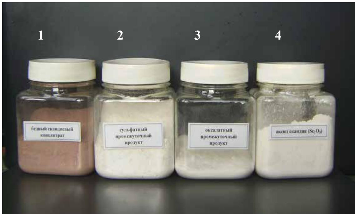
Рисунок 6.11 - Образцы промежуточных продуктов и оксида скандия: бедный скандиевый концентрат (1), сульфатный промежуточный продукт (2), оксалатный промежуточный продукт (3), чистый оксид скандия (4)
