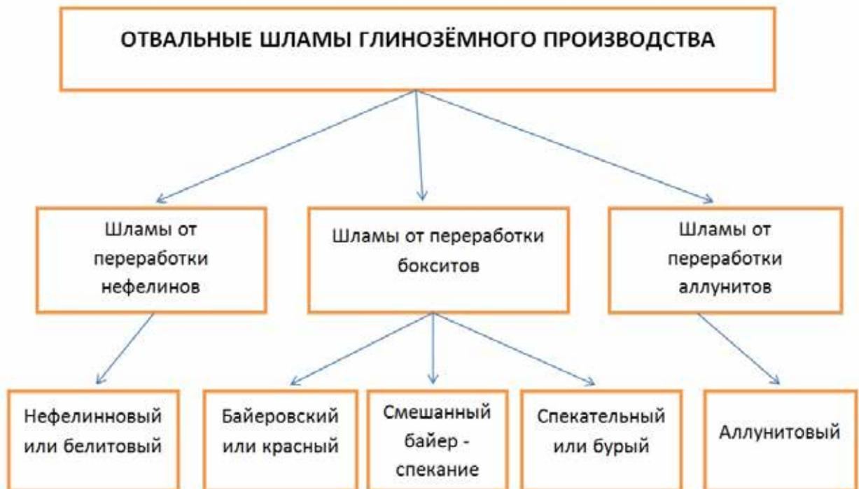
Рисунок 1.3 – Классификация отвальных шламов глиноземного производства [3,62]
