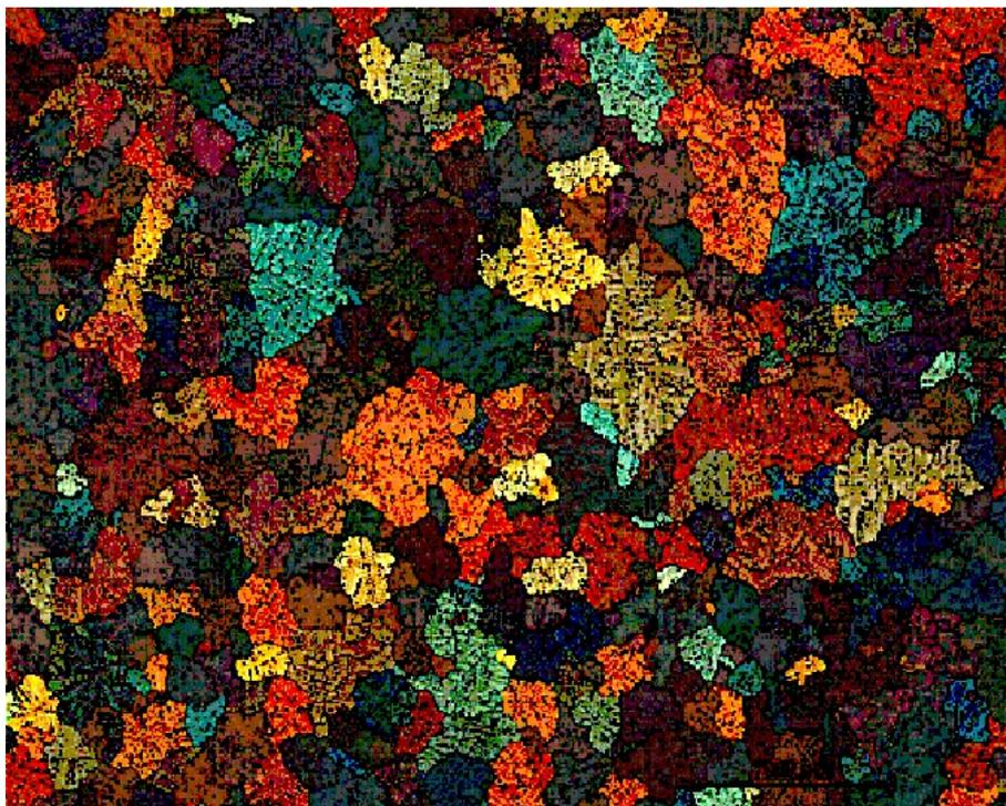
Рисунок 7.10 - Микроструктура основного объема слитка
