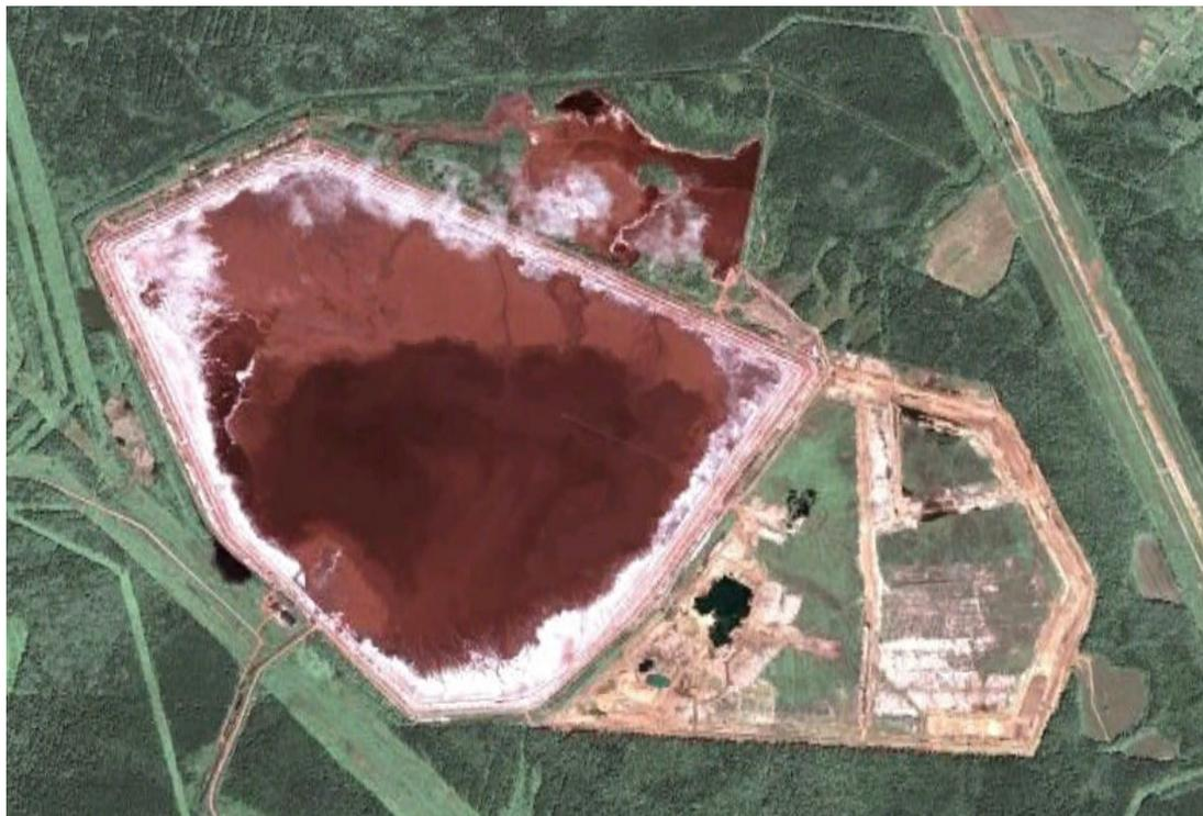
Рисунок 1.2 - Действующие шламовые поля Богословского алюминиевого завода: слева-заполненный шламом и справа - контуры границ нового шламового поля
