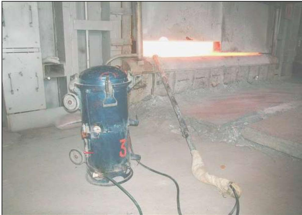
Рисунок 7.5 - Промышленная установка «УФР-20» для инъекции технологического порошка в жидкий сплав (ОАО КУМЗ)
