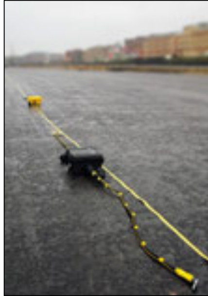
Рисунок 4.50 – Бесконтактный измеритель кажущихся сопротивлений (БИКС) в процессе съемки
