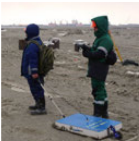
Рисунок 4.18 – Рабочий момент георадиолокационного профилирования
