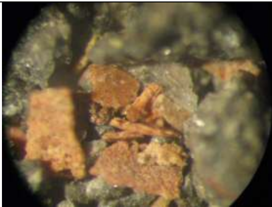
Рисунок 5.13 - Проявлена резорбция на гранях кварца и появление реакционных каемок. (Общий вид псевдокварцолита после стационарного режима; снимок под бинокляром с ув. 25*).
