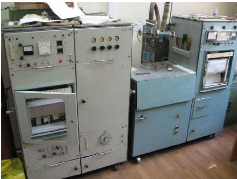
Рисунок 2.6 - Общий вид газового хроматографа ЛХМ-80, конструктивно соединенного с вакуумным декриптографом ВД-4
