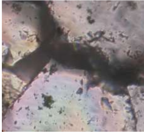
Рисунок 4.4 - Трёхлучевое высокоуглеродистое включение и многочисленные газожидкие и полупрозрачные включения в кварцевом гидротермалите. Ув. 400*.
