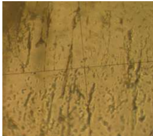
Рисунок 4.8 - Система вторичных расшнурованных газовой-жидких и полупрозрачных включений в псевдокварцолите. Ув. 600*
