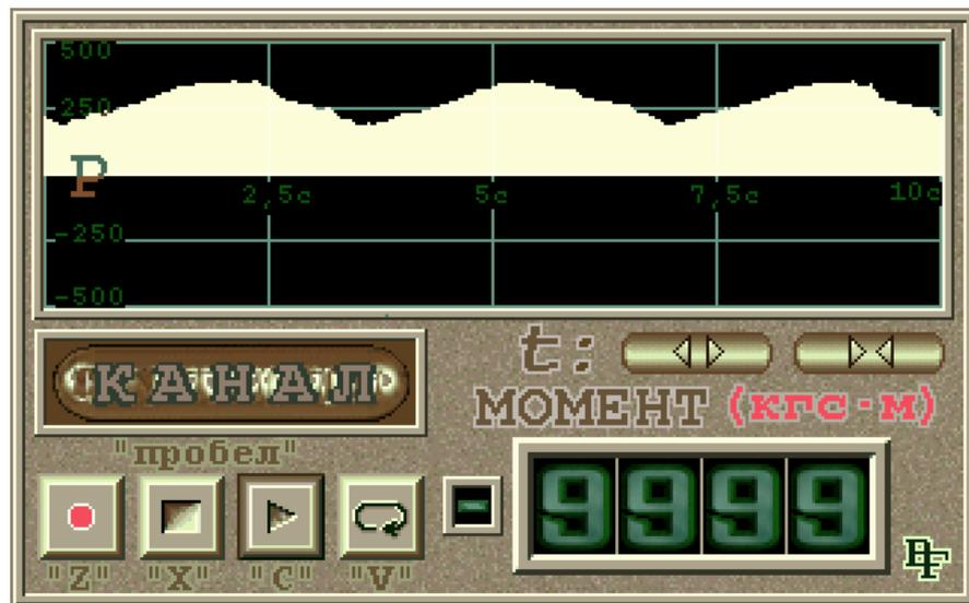
Рисунок 3.6 – Осциллограмма мощности при осевой нагрузке 160 кН
