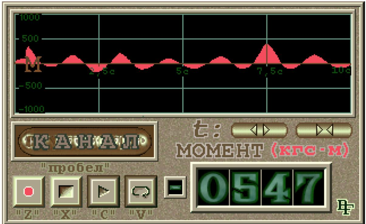
Рисунок 5.4 – Осциллограмма динамического приращения момента при осевой нагрузке 180 кН
