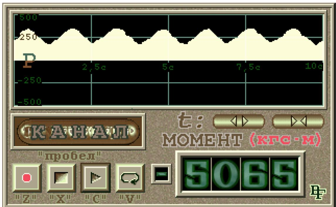
Рисунок 5.6 – Осциллограмма мощности при осевой нагрузке 180 кН
