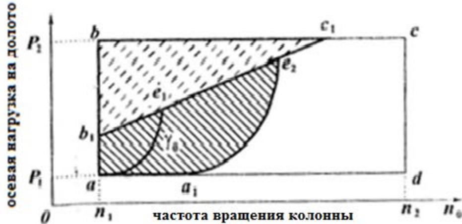
Рисунок 3.8 – Диаграмма зон работы бурильной колонны в области регулирования режимными параметрами [109]
