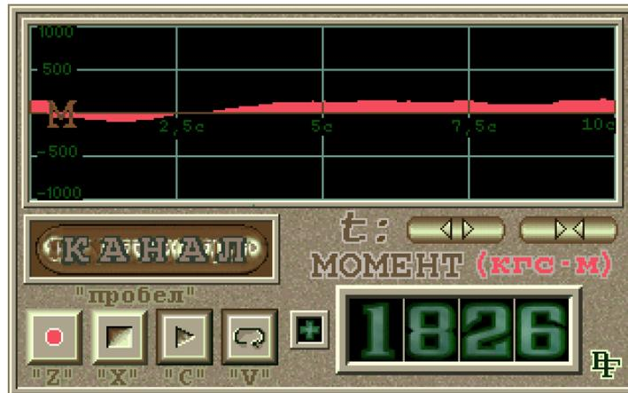
Рисунок 2.8 – Осциллограмма динамического приращения момента при осевой нагрузке 140 кН
