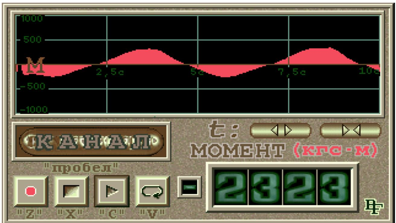
Рисунок 5.3 – Осциллограмма динамического приращения момента при осевой нагрузке 160 кН
