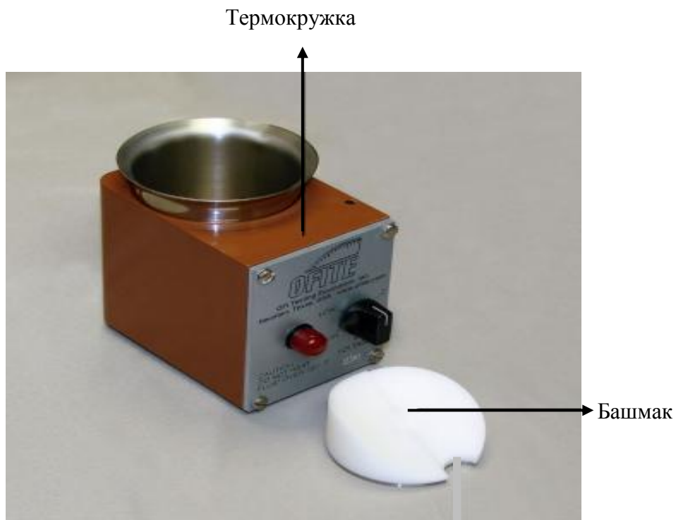
Рисунок 2.11 – Набор для проведения теста на седиментационную устойчивость бурового раствора («Dynamic Sag Shoe test»)
