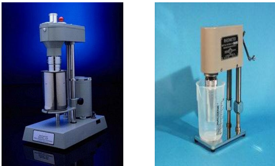
Рисунок 2.4 – Модели ротационных вискозиметров: а) электрический б) ручной
