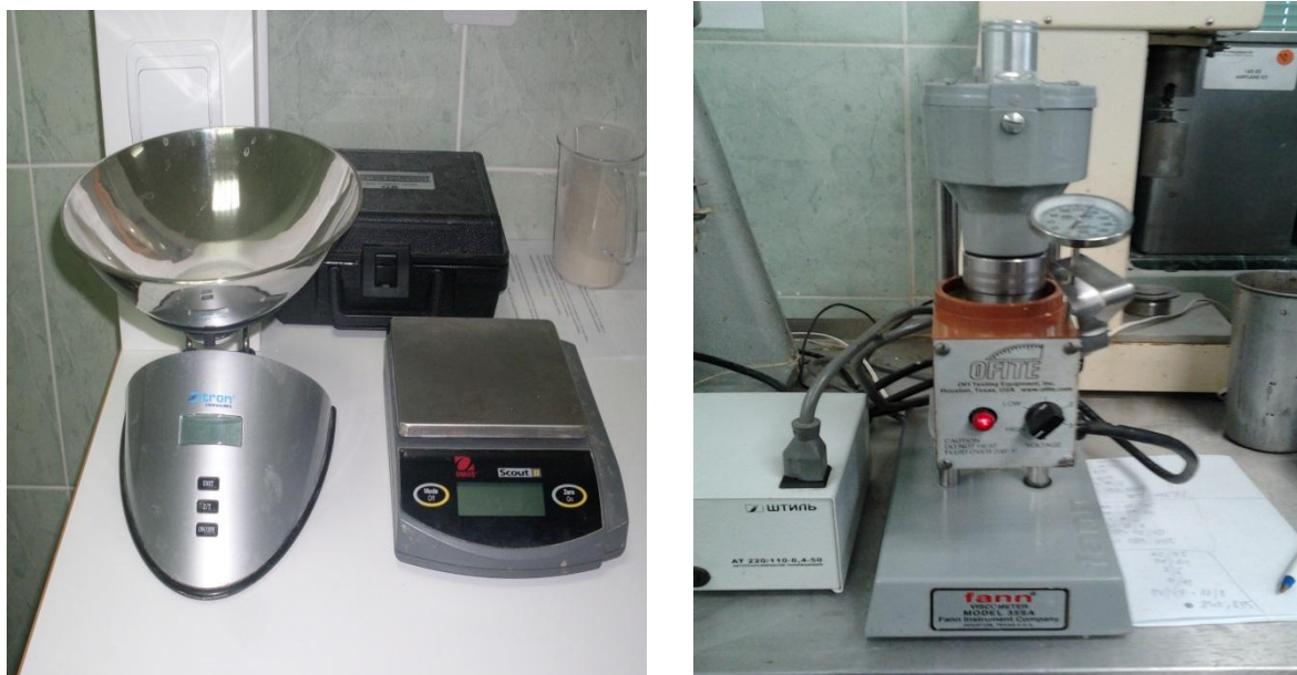
Рисунок 2.12 – Оборудование для проведения теста на испарение эмульсии
