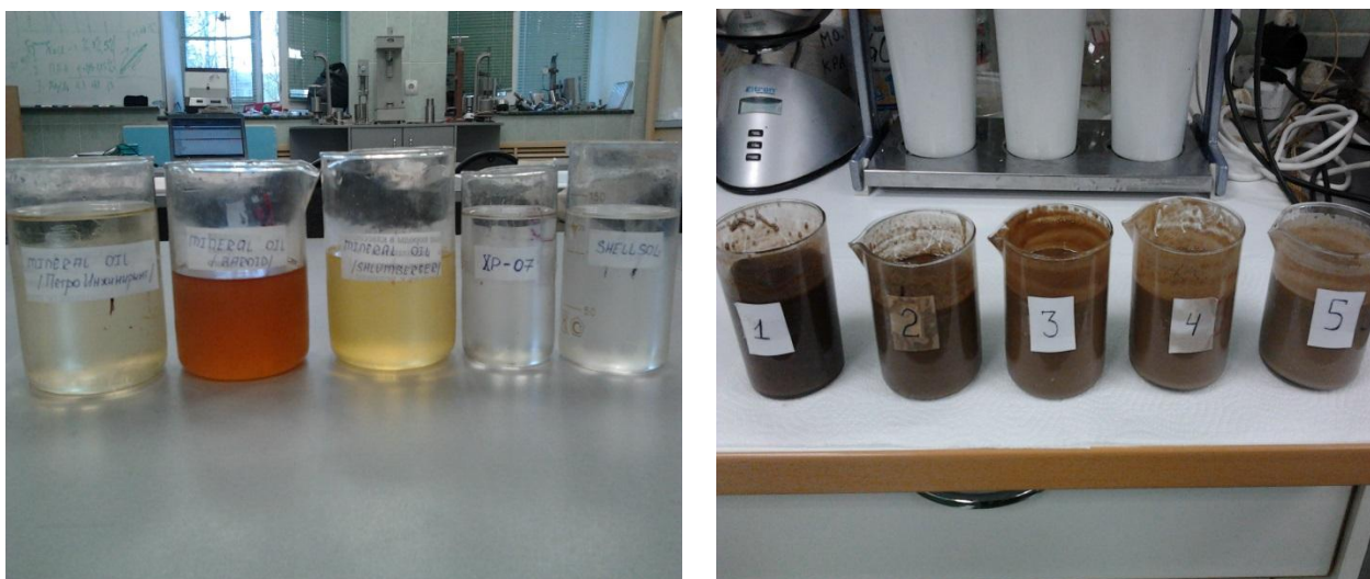
Рисунок 3.4 – Внешний вид тестируемых масел до и после обработки УВ добавками Используемые асфальто-смолистые вещества:
