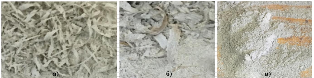
Рис. 4.2 Форма шлама в зависимости от угла установки резца PDC : а – при \alpha = 45^\circ ; б – при \alpha = 55^\circ ; в – при \alpha \geq 65^\circ .
