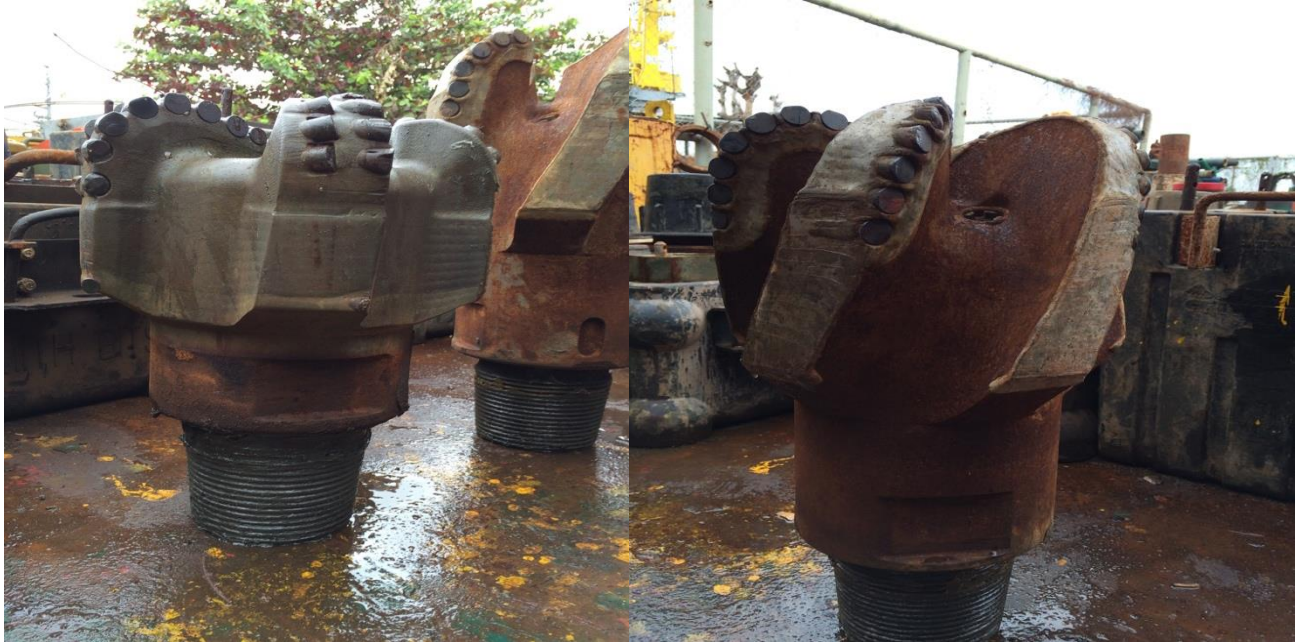
Рис. 1.7 Долота PDC с отрицательным углом установки резцов.
