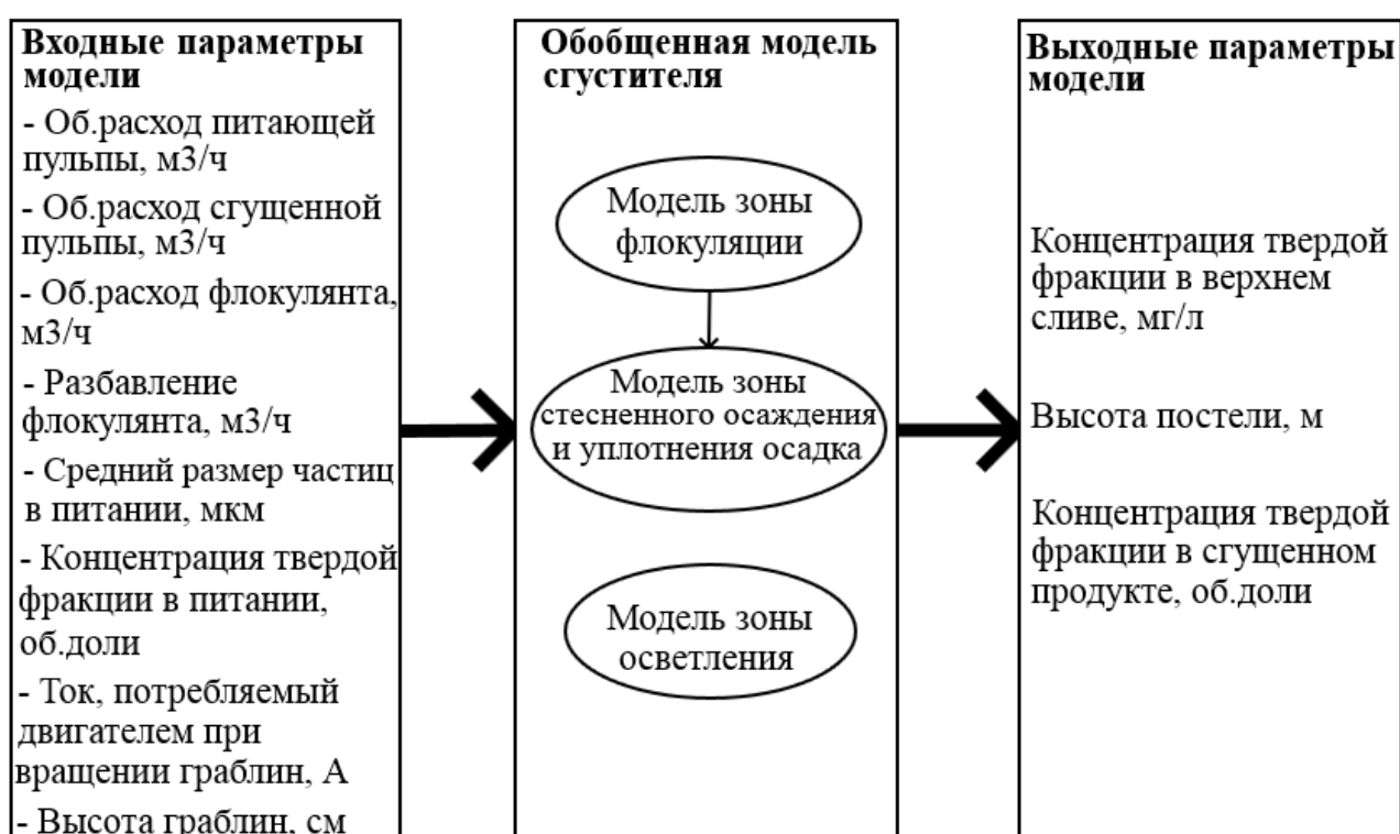
Рисунок 3.31 – Схема обобщенной модели сгустителя
