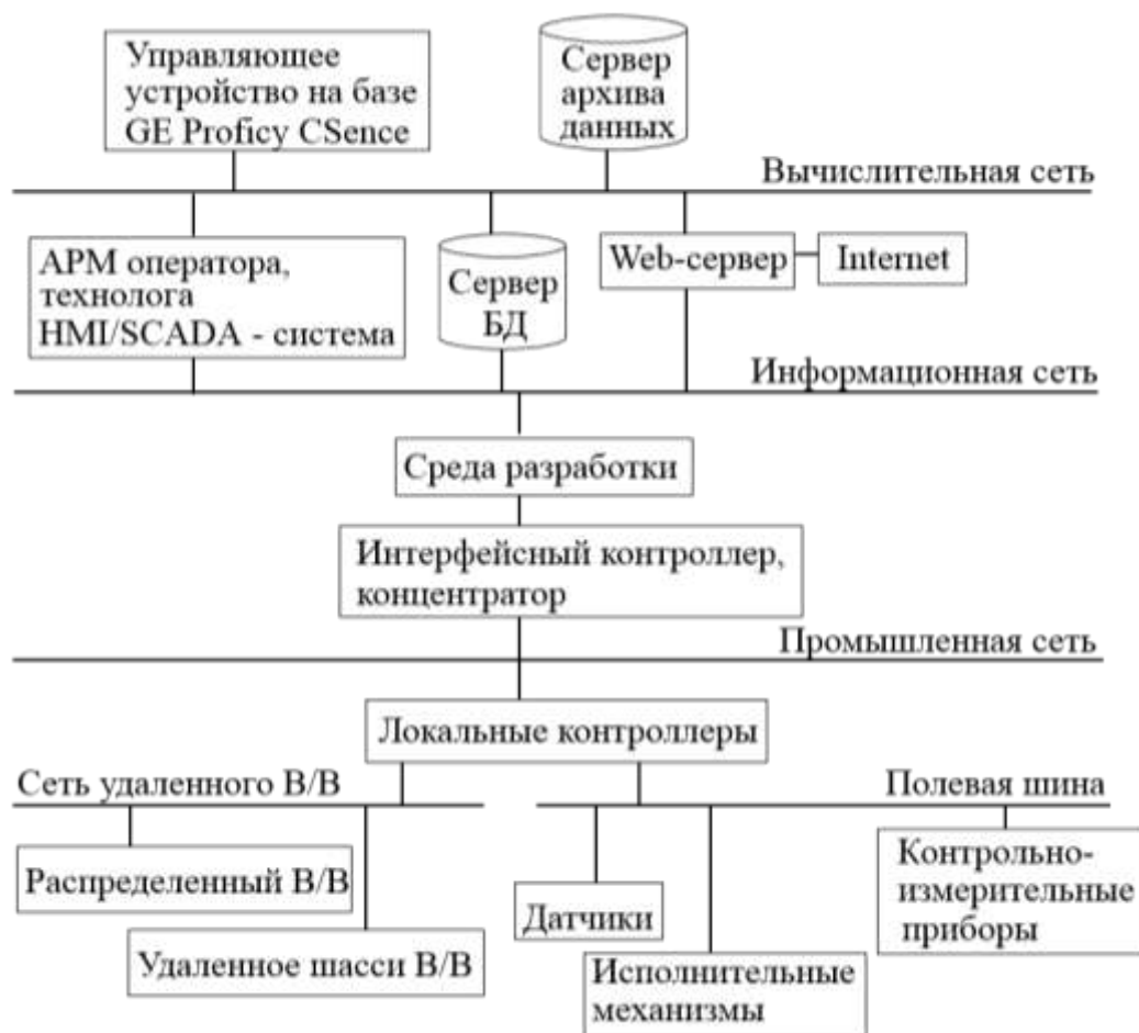
Рисунок 4.8 – Положение УУ на базе алгоритма распределения питающей пульпы между параллельными сгустителями в СУ
