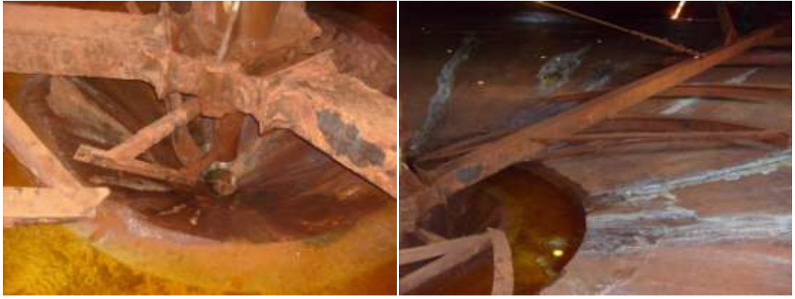
Рисунок 2.3 – Разгрузочная воронка в центре чана
