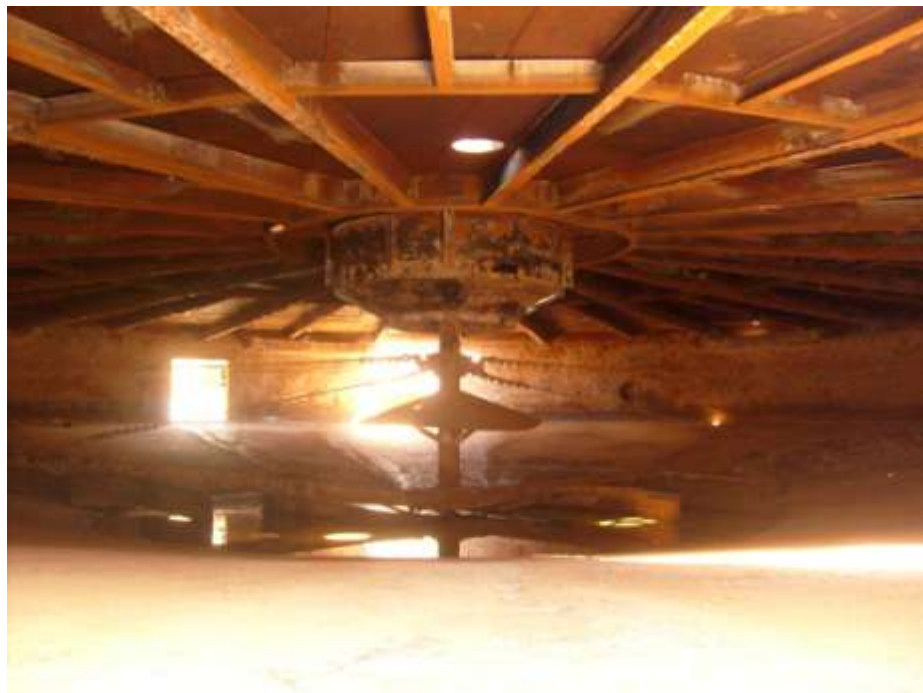
Рисунок 2.2 – Радиальный одноярусный сгуститель классического дизайна
