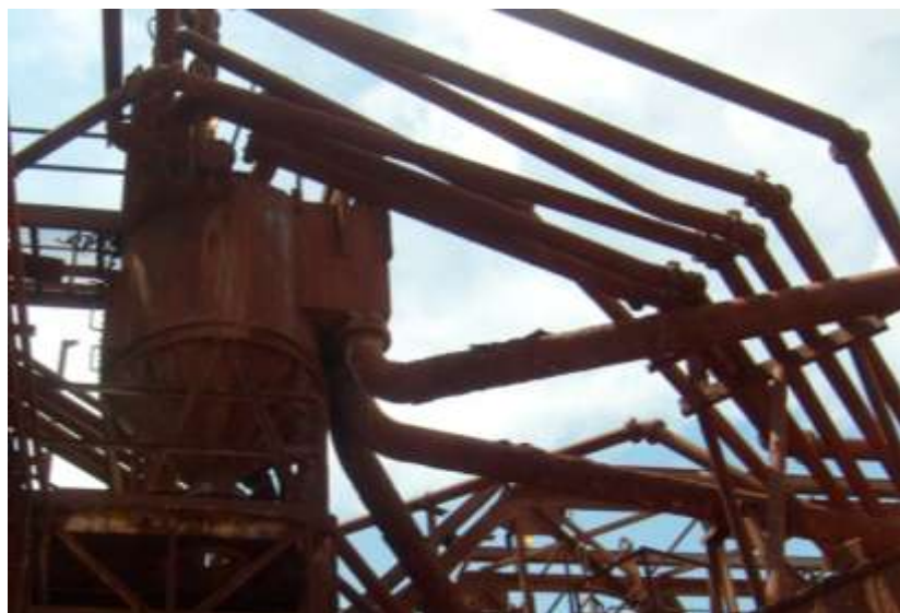
Рисунок 2.5 – Распределительная питающая коробка
