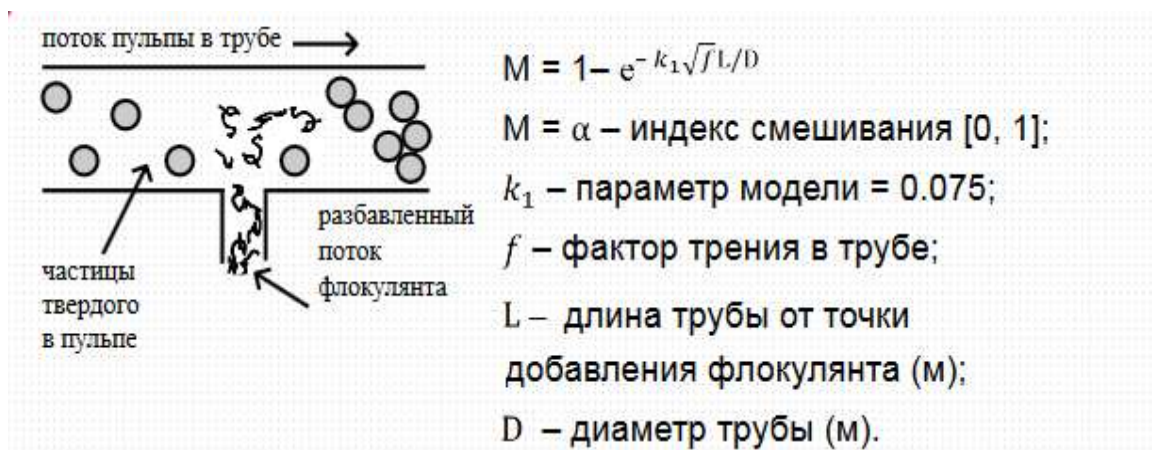
Рисунок 3.9 – Адсорбция флокулянта на поверхности частиц в процессе перемешивания
