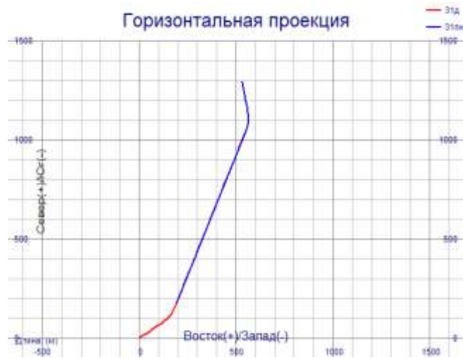
Рисунок 1.25 – Горизонтальная проекция добывающей № 31Д и паронагнетательной № 31ПН скважин Лыаельской площади
