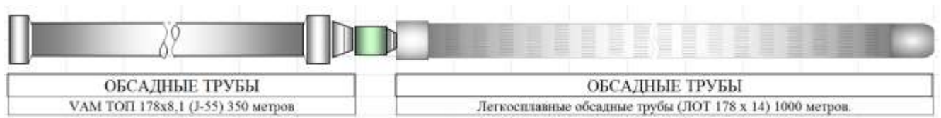
Рисунок 4.15 – Компоновка для спуска щелевого фильтра для условий Лыаельской площади Ярегского нефтяного месторождения
