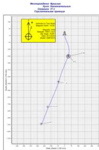
Рисунок 1.42 – Горизонтальная проекция стволов скважин №№ 31Д, 31Н
