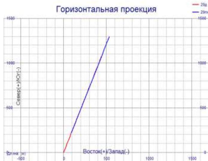
Рисунок 1.31 – Горизонтальная проекция добывающей № 29Д и паронагнетательной № 29ПН скважин Лыаельской площади
