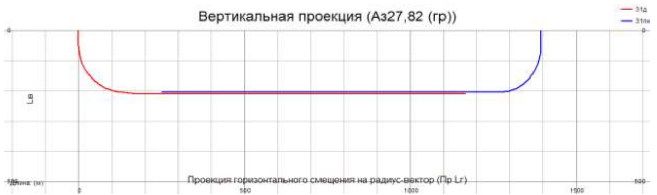
Рисунок 1.24 – Вертикальная проекция добывающей № 31Д и паронагнетательной № 31ПН скважин Лыаельской площади (бурящихся с разных площадок на расстоянии 1400 метров)
