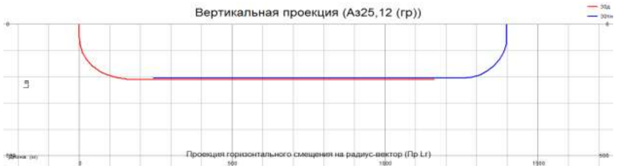
Рисунок 1.27 – Вертикальная проекция добывающей № 30Д и паронагнетательной № 30ПН скважин Лыаельской площади (бурящихся с разных площадок на расстоянии 1400 метров)
