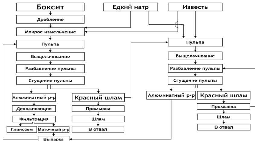
Рисунок 11 - Схема автоклавной обработки красного шлама с автономным технологическим блоком.
