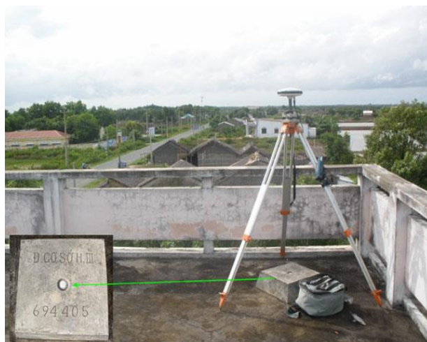
Рисунок 1.21 – Вид пункта ГГС (на крыше здания)
