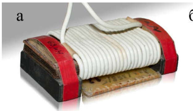
Рисунок 4 — Внешний вид импульсного П-образного электромагнита (а), полученная осциллограмма зондирующего и подмагничивающего импульсов (б)
