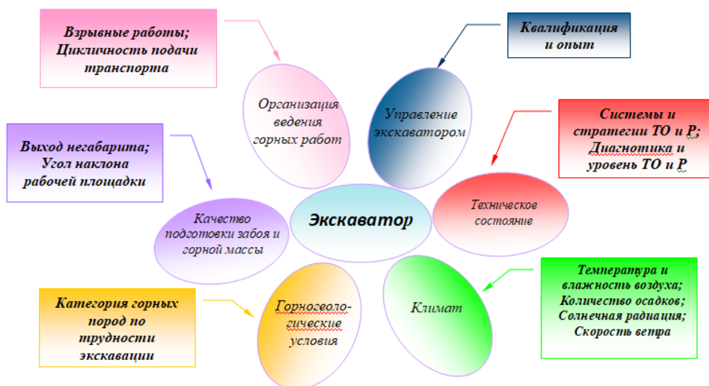
Рисунок 2.1 – Факторы, воздействующие на изменение технического состояния карьерного экскаватора
