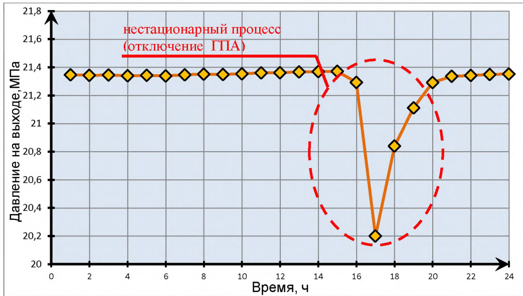
Рисунок 3.5. – Изменение давления на выходе из КС «Портовая» магистрального газопровода «Грязовец-Выборг» в результате отключения ГПА
