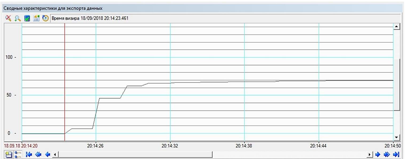
Рисунок В1 – Экспериментальные данные разгона детандера при p_1 = 50 кПа
