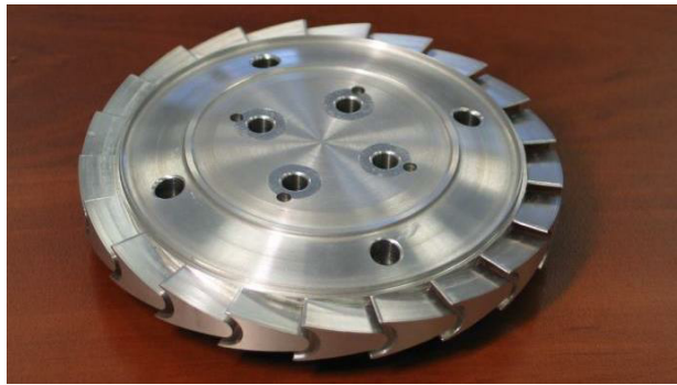
Рисунок 13 – Рабочее колесо расширительной турбины ЛПИ
