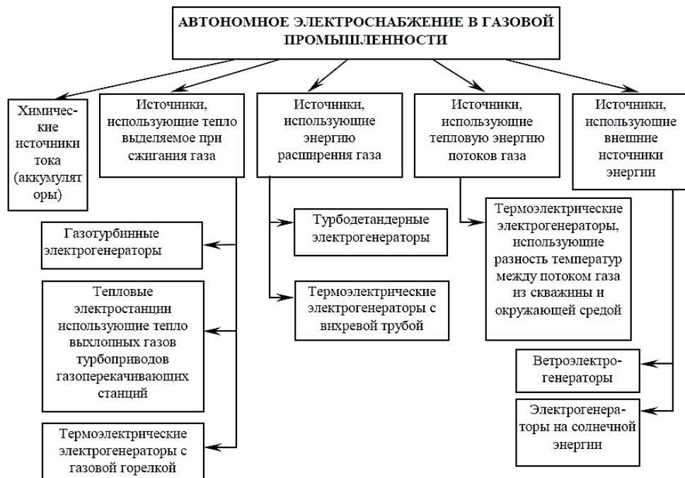
Рисунок 6 – Существующие автономные источники электроснабжения в газовой промышленности [22]
