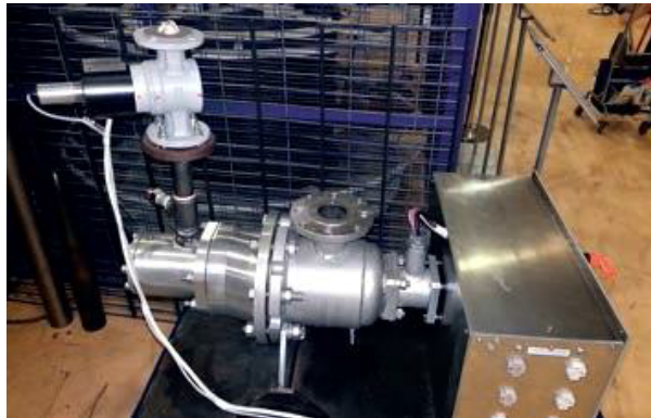
Рисунок 21 – Опытный образец ДЭА мощностью 1 кВт
