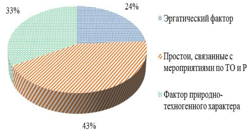
Рисунок 2 – Распределение простоев экскаватора ЭКГ-32Р № 1
