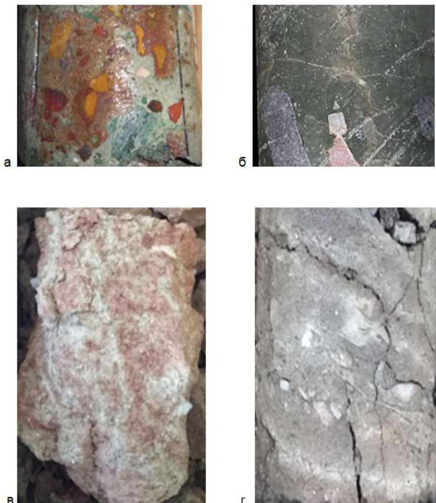
Рисунок 4.13 - Образцы керна: а – осадочная брекчия полимиктового состава; б - алевролит с неокатанными обломками гравийно-галечной размерности; в – глины с протоконкрециями и ожелезнением; г - крупнослоистый конгломератовый песчаник
