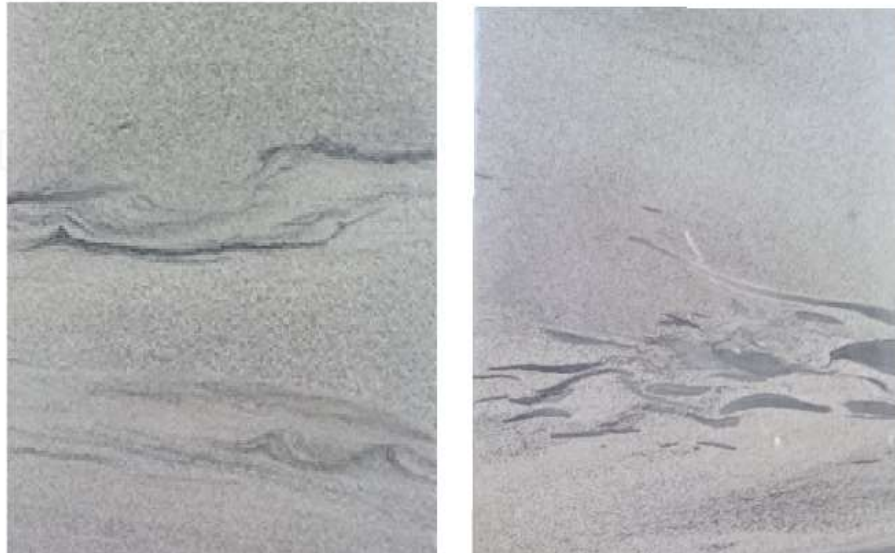
Рисунок 4.26 - Образцы керна: песчаники мелко-среднезернистые, с прослоями глинистых интракластов, частое неравномерное переслаивание глин и песчаников, зачастую нарушенное мелкой преимущественно горизонтальной биотурбацией
