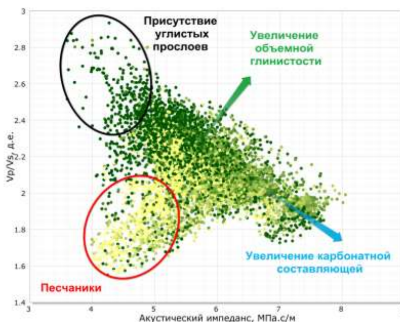
Рисунок 5.11- Кросс-плот: акустический импеданс по оси X (AI) и V_p/V_s по оси Y (материал по трем опорным скважинам)
