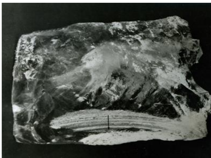
Рисунок 3.7 – Поверхность забоя при заполировании алмазной коронки
