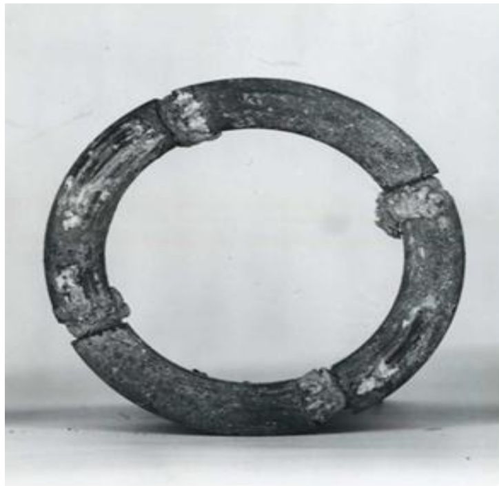
Рисунок 4.6 – Серийная однослойная коронка с промывочными каналами, перекрытыми шламом
