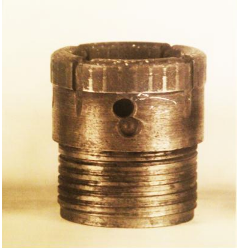
Рисунок 4.1 – Опытная коронка, в корпусе которой выполнены конусные промывочные каналы
