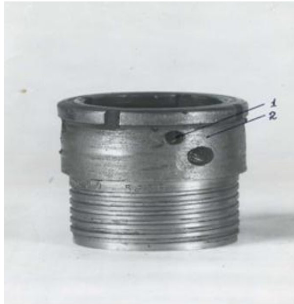
Рисунок 4.5 – Отработанная опытная коронка 1 – промывочный канал в корпусе коронки; 2 – следы абразивного воздействия шлама на корпус коронки
