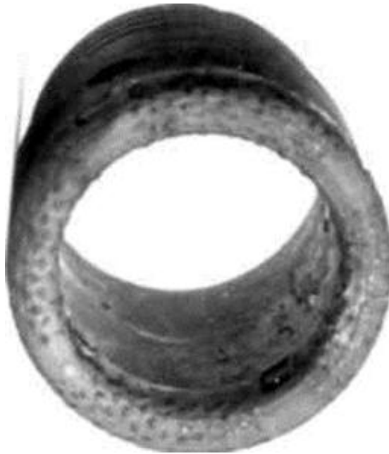
Рисунок 1.6 – Алмазная коронка со сплошной матрицей и промывочными каналами в корпусе коронки
