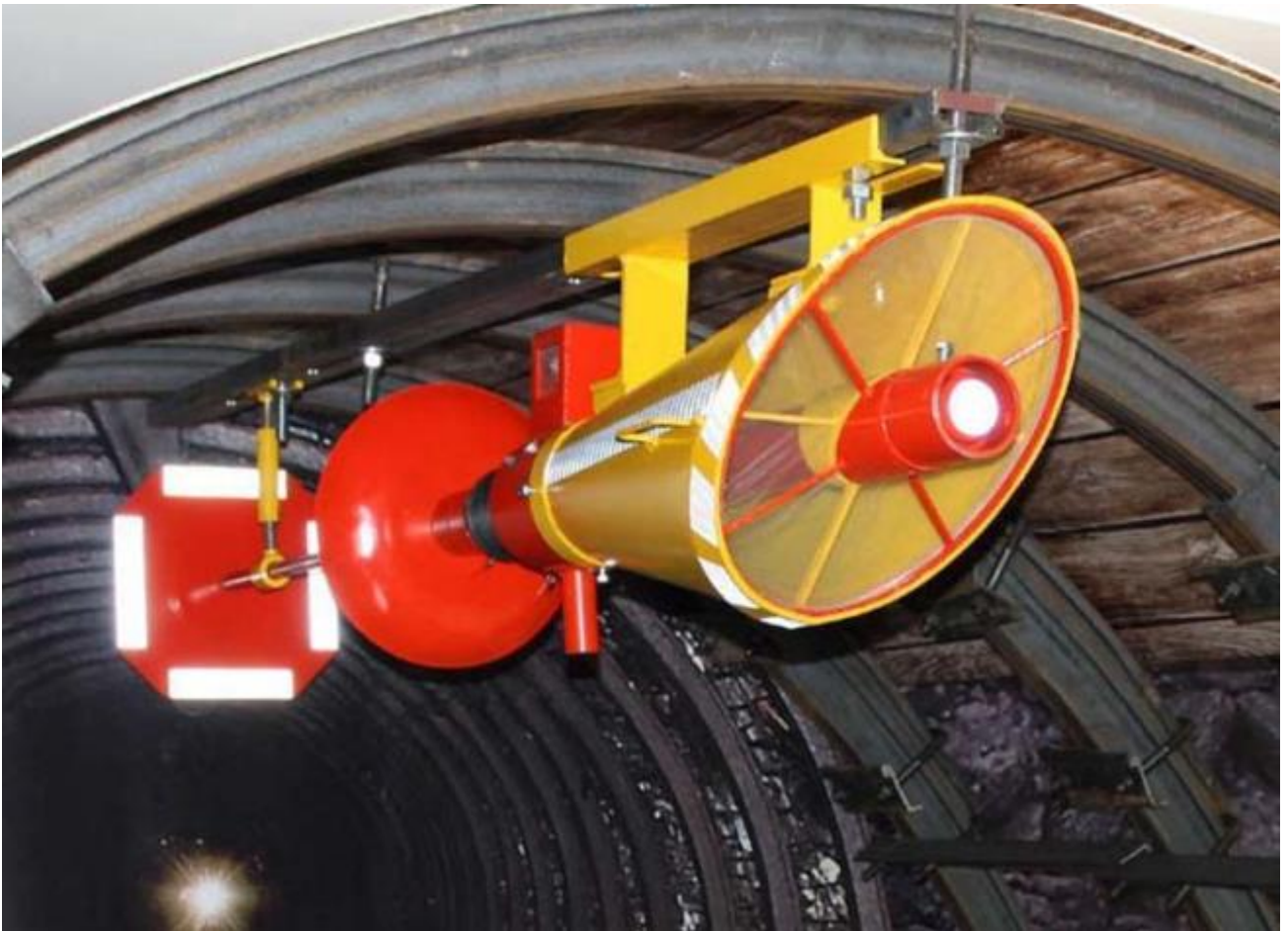
Рисунок 1.12 - Внешний вид автоматической системы взрывоподавления-локализации взрывов типа АСВП-ЛВ(.1М)
