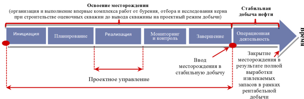
Рисунок 3 – Этапы жизненного цикла проекта разработки месторождения СВН и применение проектного и процессного управления в общей системе освоения управления проектом месторождения СВН
