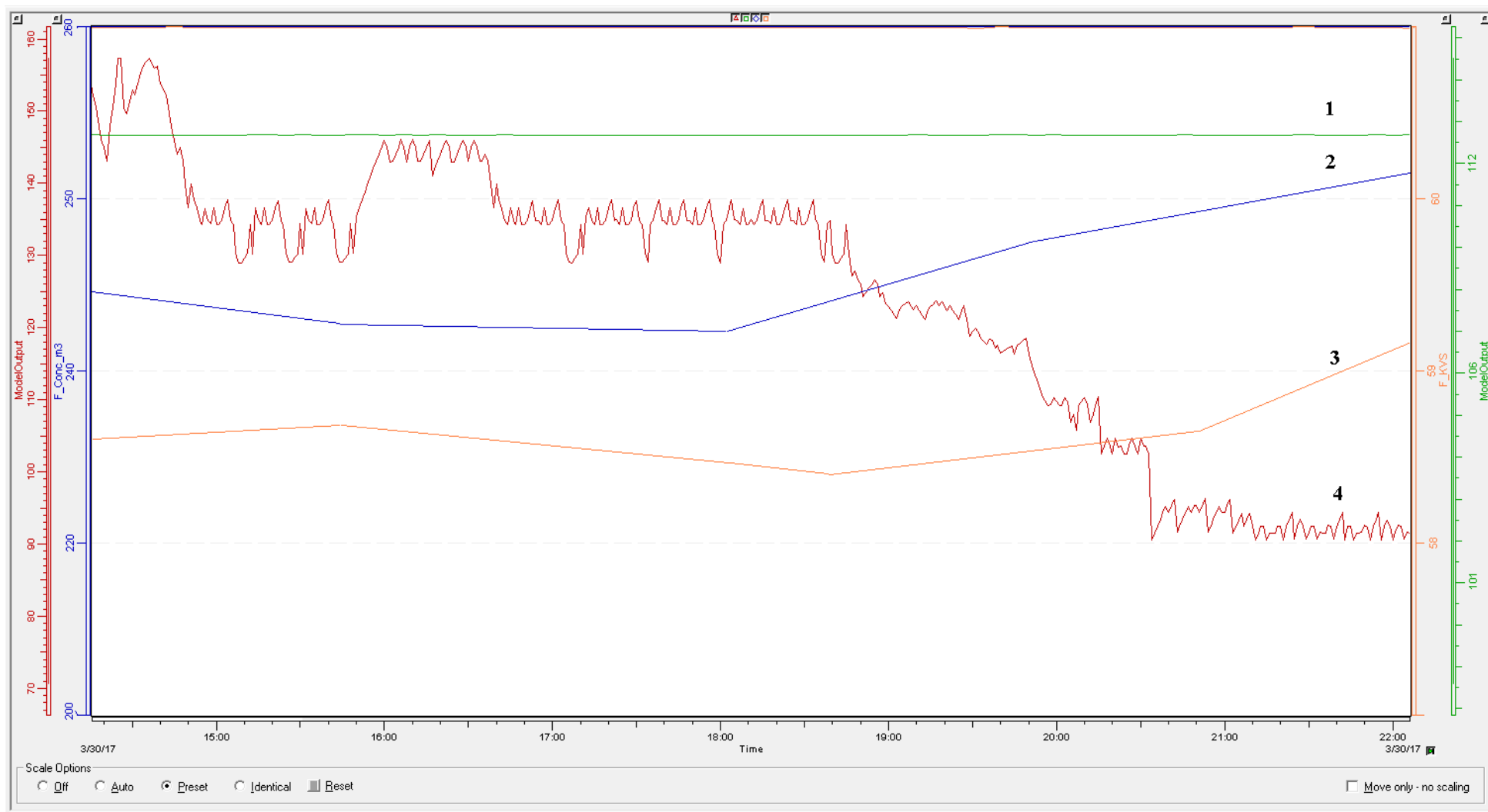
Рисунок 94 – Результаты работы оптимизационного регулятора концентрации Ni_3S_2 где 1 – регулируемая величина, 2 – расход шихты, 3 – расход КВС, 4 – архивные данные
