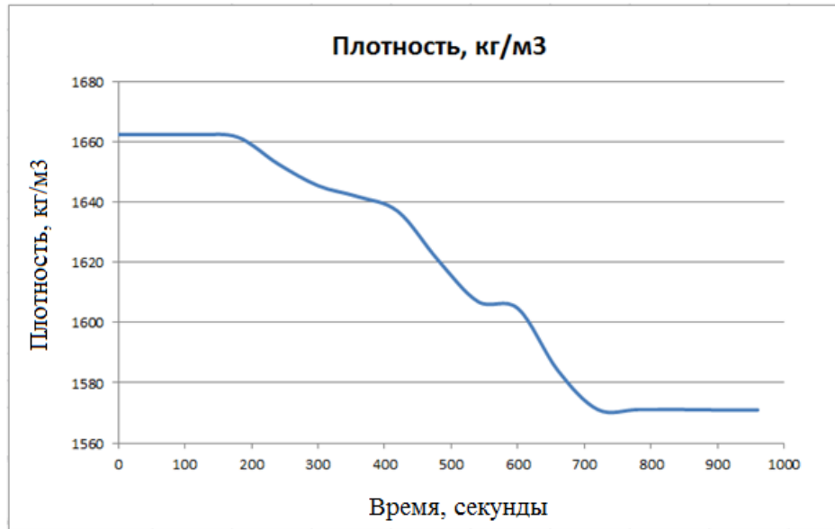
Рисунок 34 – Изменение плотности во времени после скачка разгрузки
