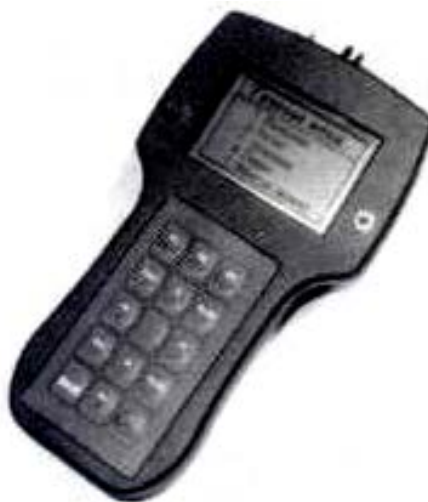
Рисунок 1.2 – Изображение прибора - анализатора ресурса подшипников –
