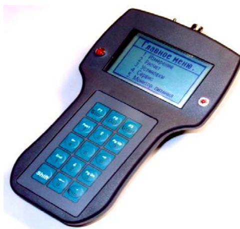
Рисунок 2.3 – Акустико-эмиссионный анализатор АРП-11
