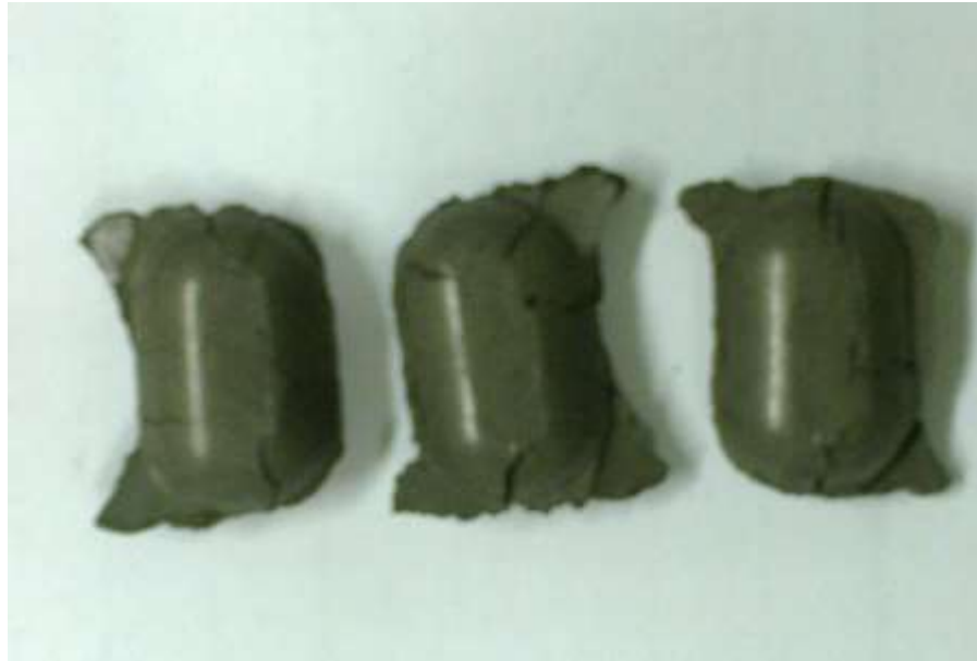
Рисунок 4.75 – Вид брикетов, полученных при использовании 10% ПВС после приложения внешней нагрузки
