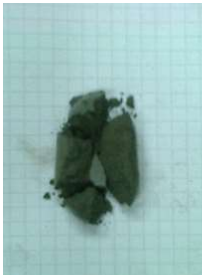
Рисунок 4.37 – Вид брикета, полученного при использовании 10% \text{NiSO}_4 после приложения внешней нагрузки
