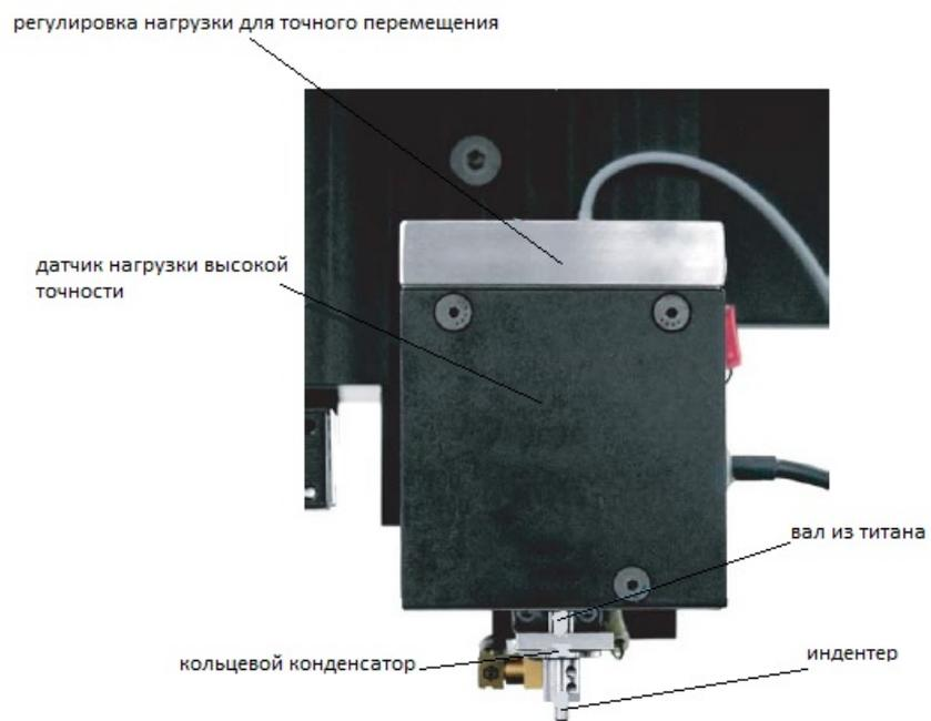
Рисунок 16 – Конструкция, реализованная компанией Nanovea
