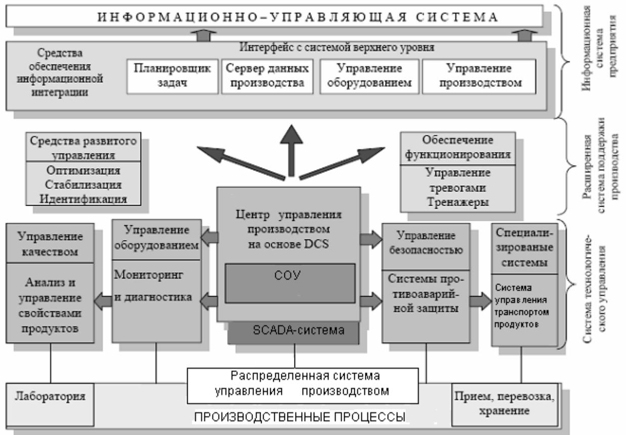
Рисунок 2.1 – Типовая структура СОУ
